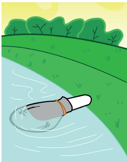
Proteção da entrada de água contra invasores.
